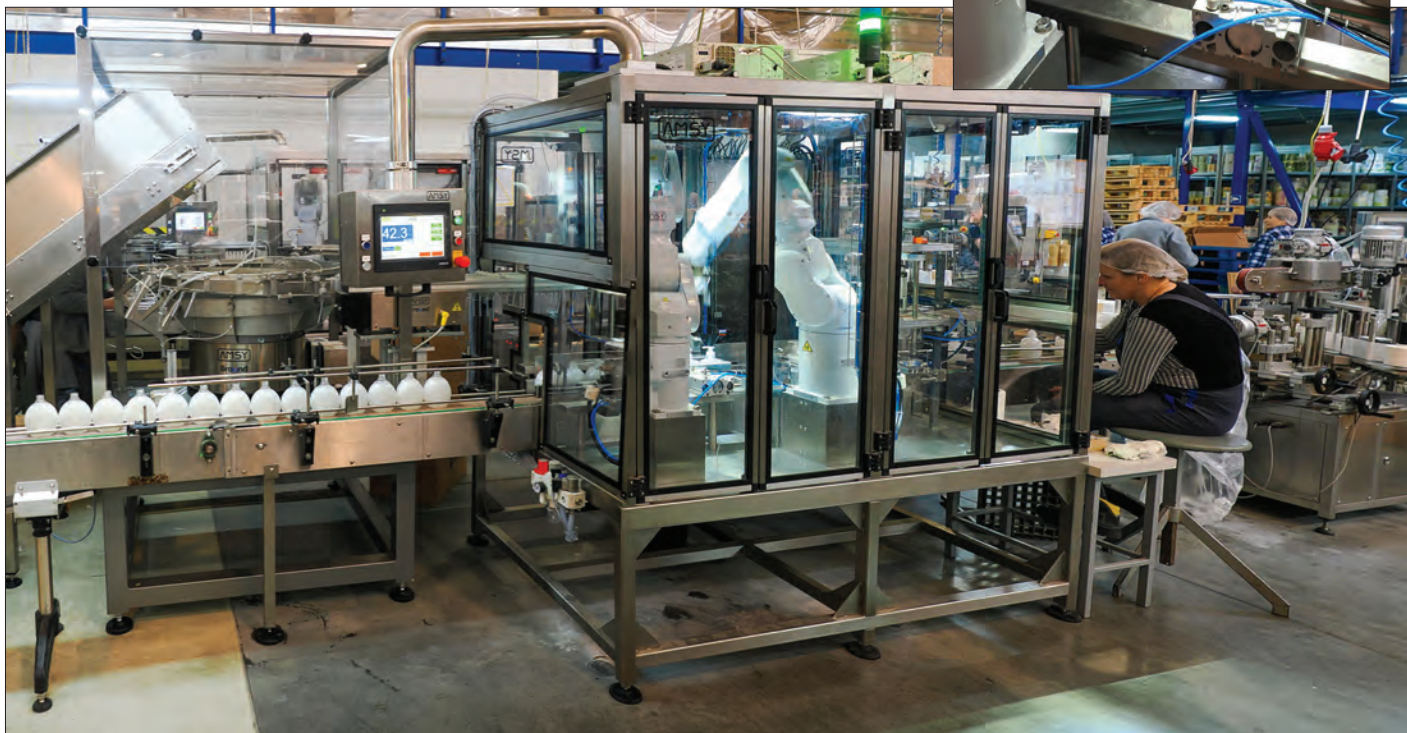
Linia rozlewnicza środków czystości z wykorzystaniem robota do nakładania zamknięć
