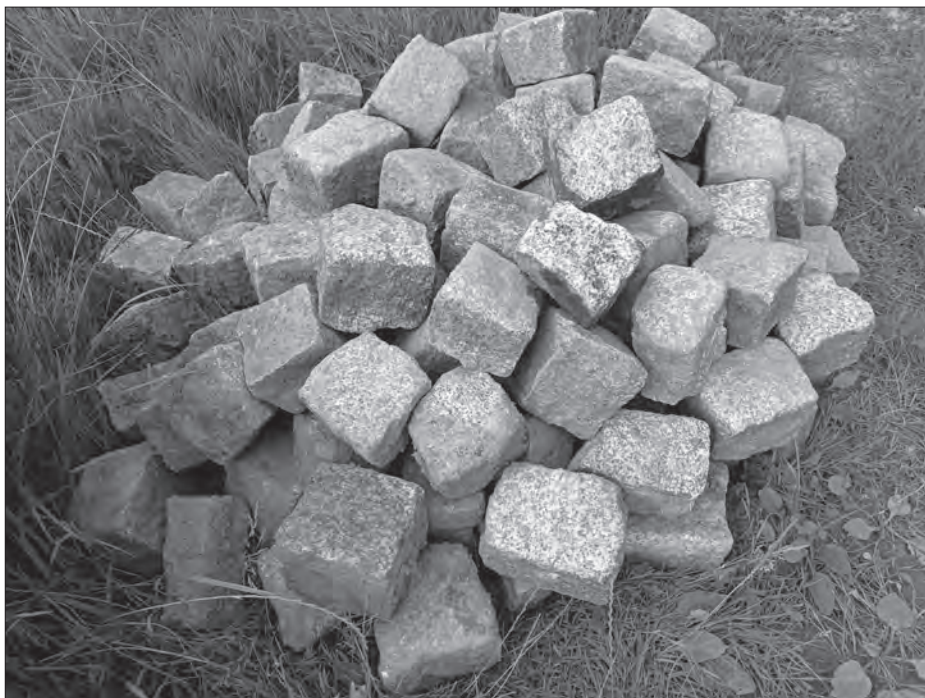
Przyna kostki brukowej odzyskana w lipcu 2021 r. z ulicy Jana Pawła II (dawniej ul. Krakowskiej) przy pracach ronda u zbiegu ulic: Kopernika, Kolejowej, Jana Pawła II
