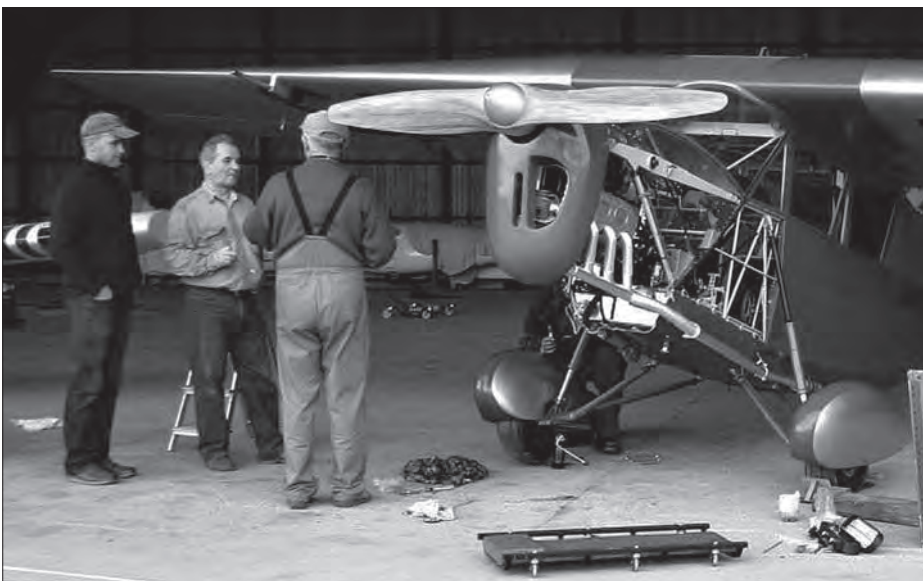
Nowo wykonane śmigło Zbyszka montowane do RWD-5
