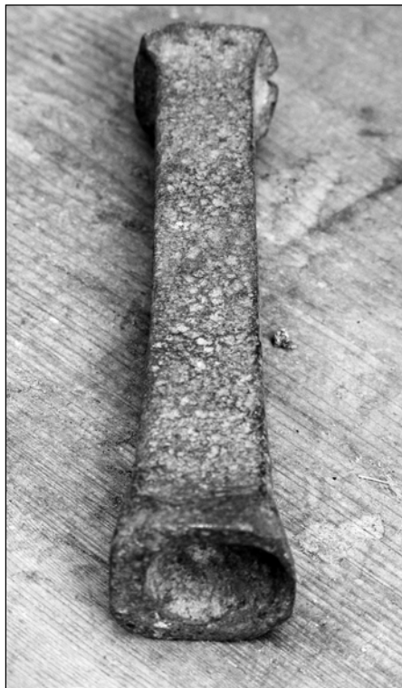
Nitownica z początku XX wieku do nitów łączących okucia dębowych drzwi kościoła.
