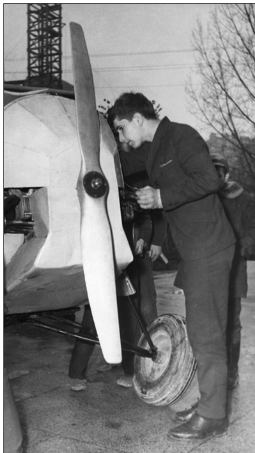
Śmigło jak widać ma prawie taką wysokość jak Zbyszek. Rozpiętość skrzydeł 6,27 m, długość kadłuba 4,05 m, wysokość 1,80 m, a cały samolot waży 160 kg i zaopatrzony jest w silnik o mocy 40 KM.
